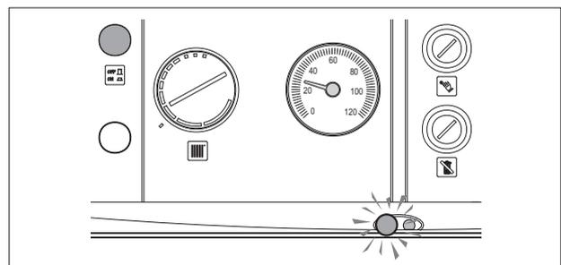
En caso de que se produzcan anomalías de encendido o de funcionamiento la caldera efectuará una "PARADA DE BLOQUEO", indicada por el encendido del indicador rojo que se encuentra en el cuadro de mandos.
