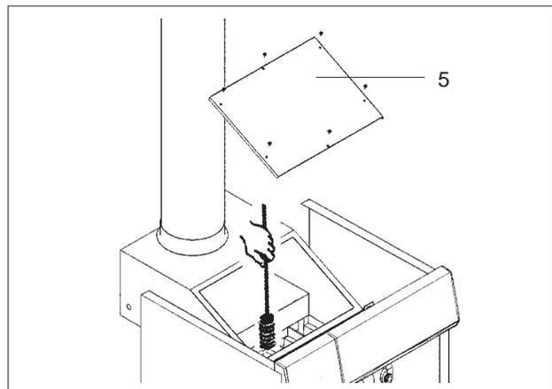
Después de haber efectuado el mantenimiento y la limpieza, montar nuevamente todos los componentes siguiendo el procedimiento inverso del descrito y comprobar la estanqueidad de las uniones.
