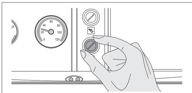
**⚠** Si el termostato de descarga de humos se activa repetidamente verificar que el conducto de descarga de los productos de la combustión no esté obstruido y haya sido realizado correctamente.
